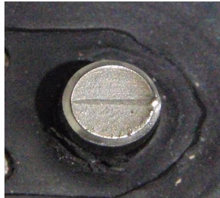
Rupture par fatigue d'une cadène en « U »
