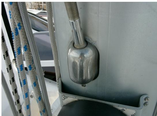
Début de corrosion sur capelage d'un hauban
